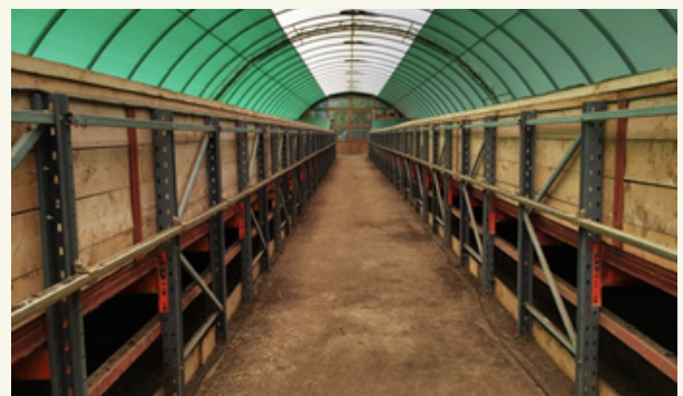
Joonis 2. Pideva läbivooluga tootmisprotsess, kompostimisrajatis sisetingimustes, Austria
